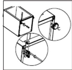
7. Встановіть дверцята на місце. Перед остаточним закручуванням верхнього шарніра переконайтеся, що дверцята вирівняно по горизонталі та вертикалі так, що ущільнювач щільно прилягає з усіх боків.
