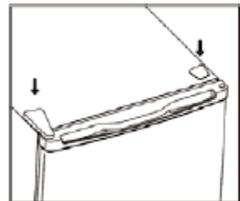
11. Від'єднайте ущільнювачі дверей від холодильної та морозильної камер, а потім знову приєднайте їх після перевертання.
